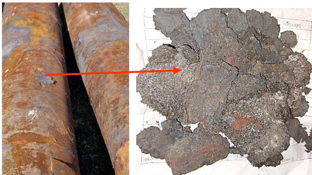
Зураг 7. Дулааны шугам хоолойн гадна талд тогтсон зэврэлтийн бүтээгдэхүүн
